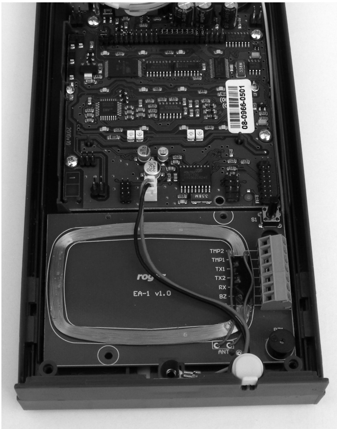
Rys.2 Instalacja modułu EA-1 w domofonie HELIOS
