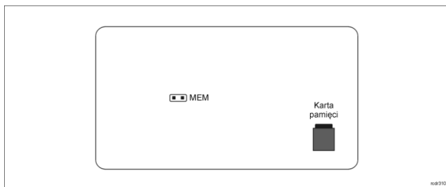
Rys. 3 Lokalizacja styku serwisowego i karty pamięci
