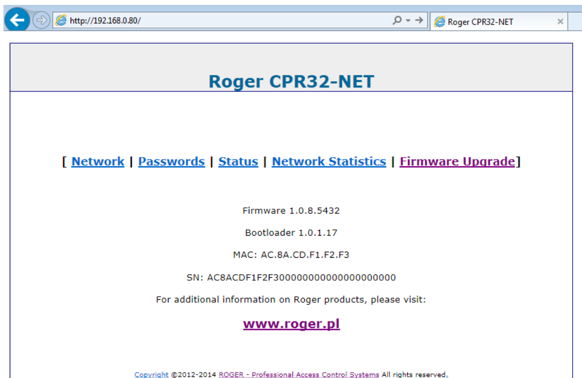
Rys. 5 Okno konfiguracyjne centrali CPR32-NET w przeglądarce internetowej
