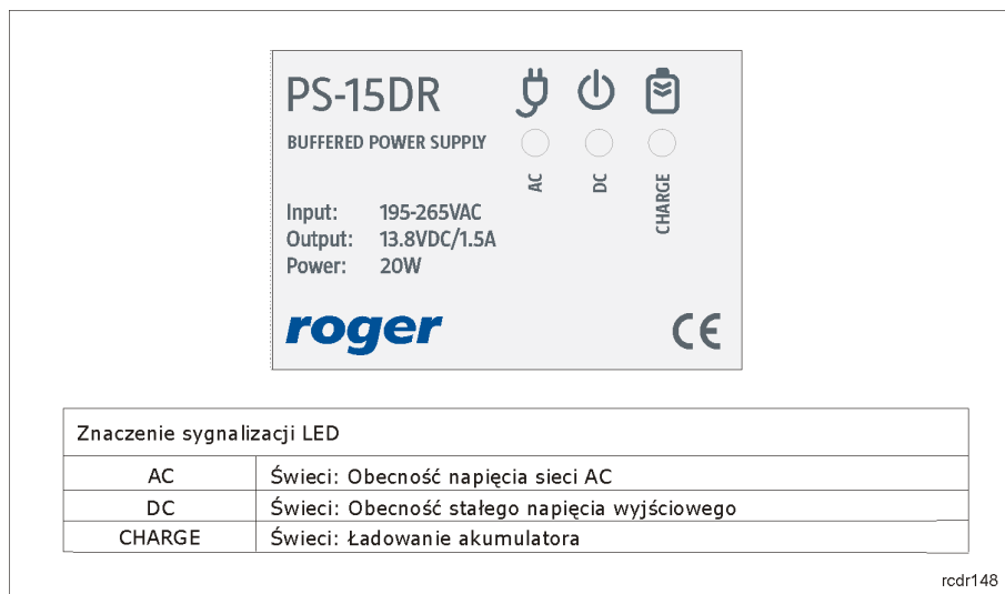
Rys.2 Lokalizacja wskaźników LED na panelu czołowym zasilacza
