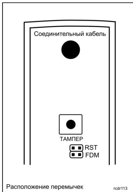
Рис. 5. Расположение контактов FDM и RST внутри корпуса контроллера PR311SE
