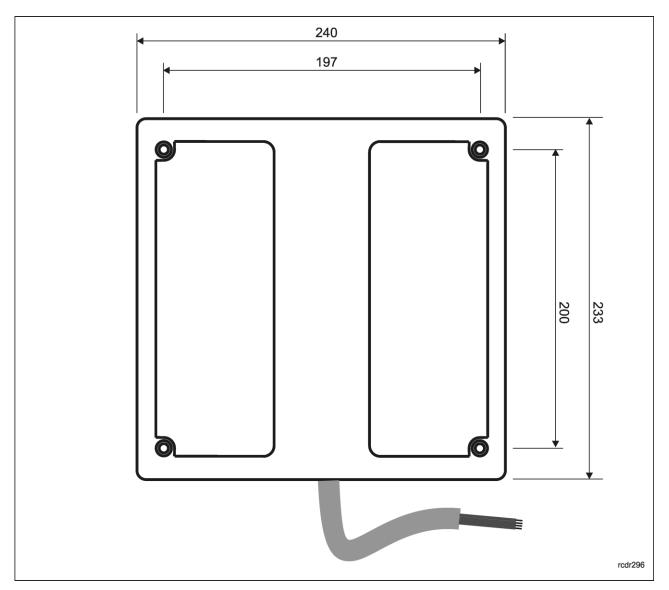
Fig. 9 LRT-1 dimensions
