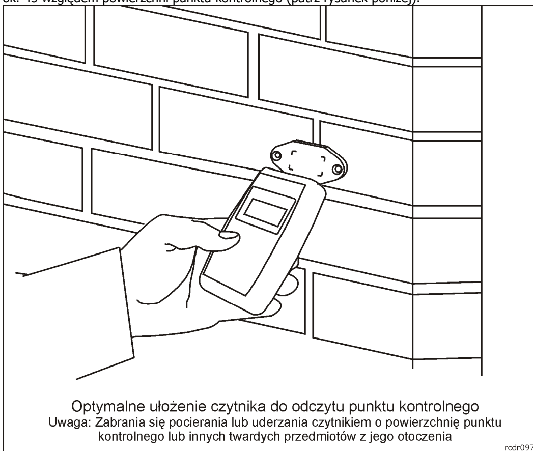
Rys.17 Przykład odczytu punktu kontrolnego PK-3
